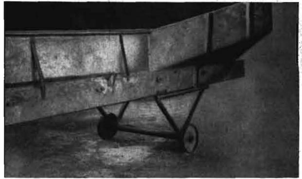
Bild 2. Montagebock für Höhenförderer ...
