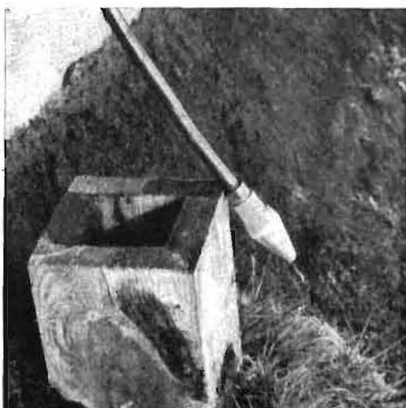
◀ Bild 4. Prüfkabel mit dem Profilkörper 30 mm Dmr.
