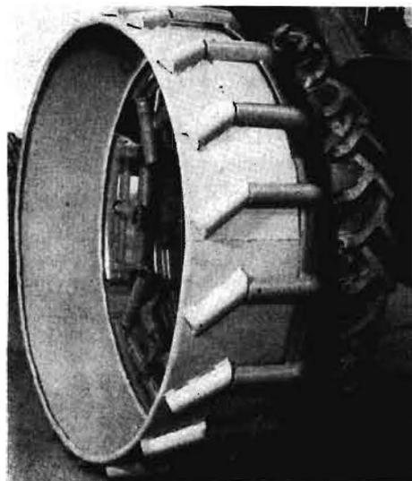
Bild 4. Kombigreiferrad mit Zusatzring als Moorverbreiterung
