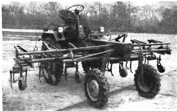
Bild 3. Maishackgerät P 153
