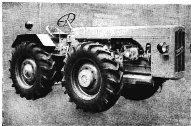
Bild 1. Prototyp eines Allradschleppers der Leistungsklasse 60 bis 70 PS des Traktorenwerkes „Roter Stern“, Budapest
