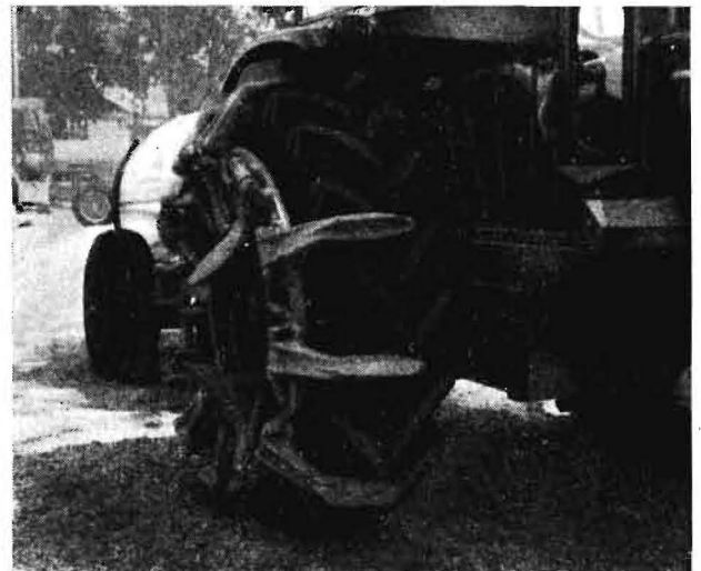
Bild 1. Mechanische Greifer an den Traktor-Hinterrädern. Sie sind vor Transportfahrten auf Straßen verhältnismäßig leicht abzunehmen
