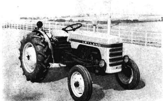
Bild 1. Leyland 384 bzw. 344. Nach Vorziehen der Kennzeichentafel lassen sich vor dem Batterie/Tank-Raum 8 Ballaststücke zu je 31,1 kg einhängen
