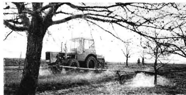
Bild 3. „Gramospray 4235“ – Spritzeinrichtung für Baumstreifen
