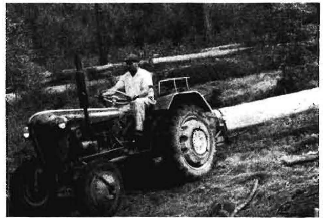
Bild 3. Polnischer Standardtraktor Ursus 28 mit hydraulischer Rückeausrüstung. Noch nicht komplett ausgerüstet, es fehlen sturzfeste Kabine und Seilwinde
