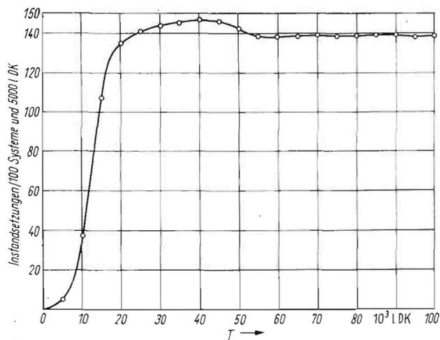
Bild 2. Instandsetzungsintensität eines Systems am Beispiel eines Traktors
