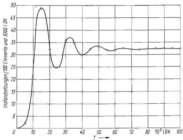
Bild 1. Darstellung der Instandsetzungsintensität beim Steuerblock des MTS-50 über der Nutzungsdauer
