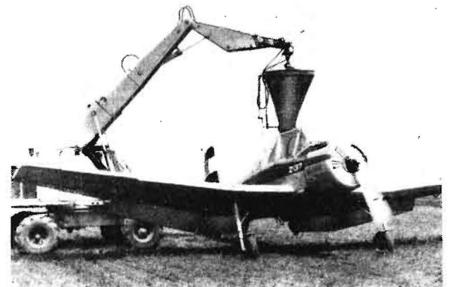
Bild 1. Mobilkran T 174 beim Beladen des Agrarflugzeuges Z-37
