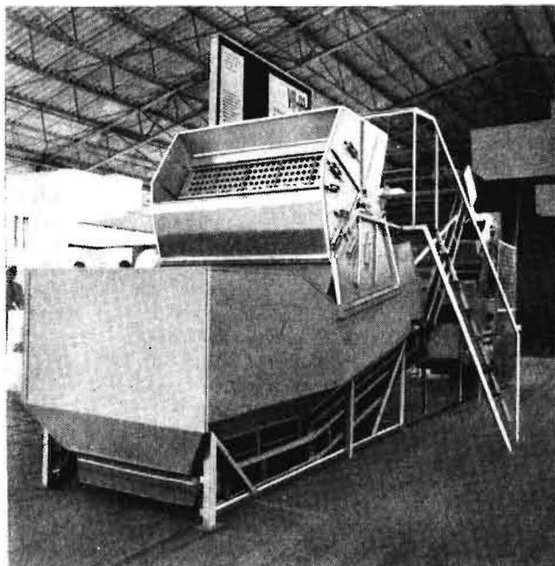
Bild 1. Ansicht der Rosenkohlaufbereitungsanlage
