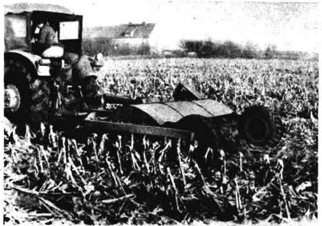
Bild 1. Für die Restmaiszerkleinerung und -verteilung umgebauter Schlegelernter mit einer Arbeitsbreite von 2,25 m im Einsatz
