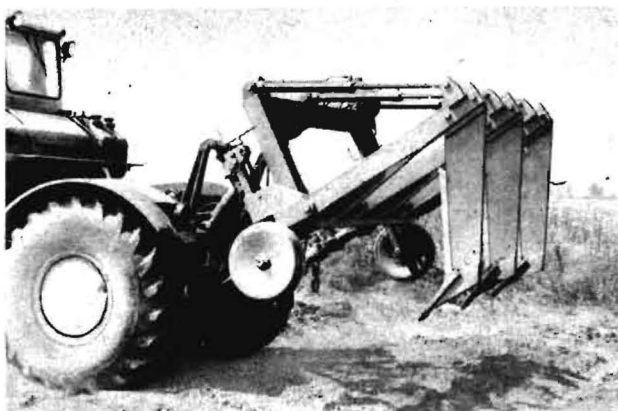
Bild 2. Gerät am Traktor K-700 (Transportstellung)
