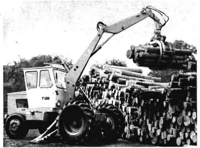
Bild 5. Neu im Angebot: Hydraulischer Drehkopf, Schwenkbereich 260°. Er dient zum Drehen der Arbeitswerkzeuge um die eigene Achse
