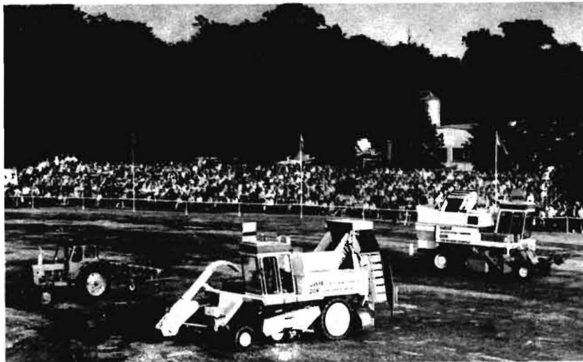
Bild 1. Ungeteiltes Interesse aller Besucher des Vorführings der VVB Land- und Nahrungsgütertechnik fand das neue Maschinensystem für den Rübenanbau, im Bild die Einzelkornsämaschine A 697, das Entwicklungsmuster eines selbstfahrenden Köpfladers und der Rodelader KS-6
