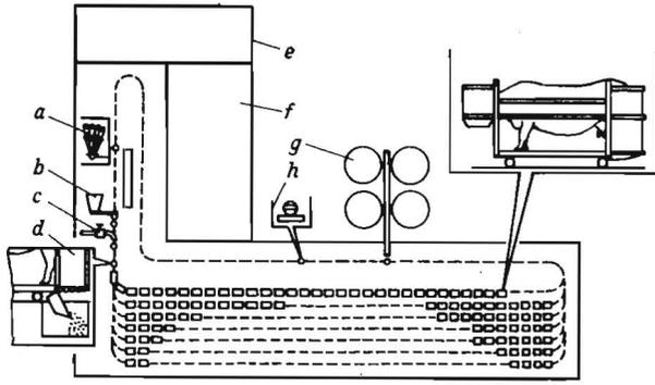
Bild 4. Schema eines Kuhstalls mit einem Förderer „UNIKAR“ der Firma „ALFA-LAVAL“: a Melkmaschinen, b Kraftfutterbehälter mit Dosiervorrichtung, c Hahn zum Füllen der Wasserbehälter, d Jauchegrube, e Milchhaus, f Laufstall für die Reproduktionsherde, g Hochbehälter für die Hauptfutterarten (Gärfutter, Heu), h Kuhwaage
