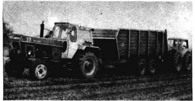
Bild 6. Traktor ZT 300 mit 12-t-Aufsattelanhängen (Funktionsmuster); in der hinteren Achse des Aufsattelanhängers sind die Radmotoren eingebaut
