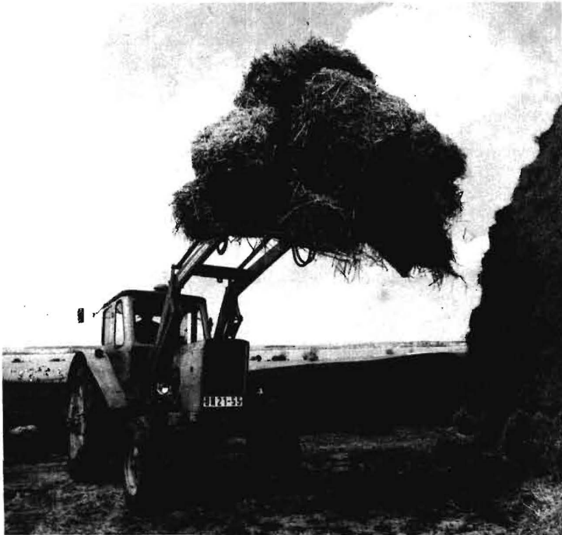
Bild 1. Frontlader T 182 beim Laden von gepreßten Strohballen mit Ladegabel und Klappgreifer
