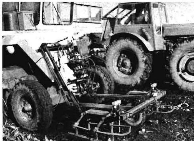
Bild 5. Automatische Lenkung des Rodeladers
