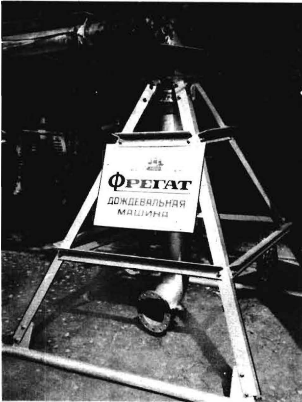
Bild 2. Zentralhydrant der FREGAT
