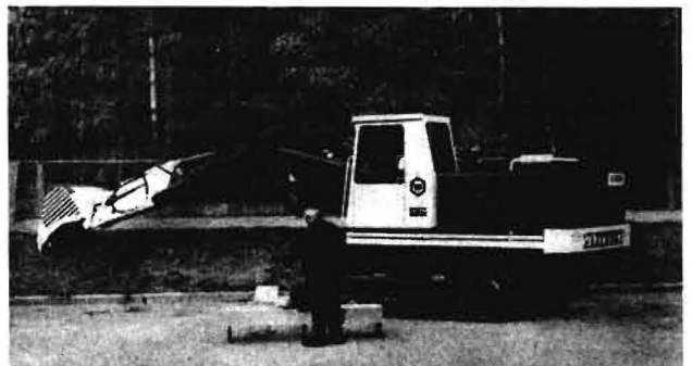
Bild 7. Hydraulischer Universalbagger K 606 (VR Polen)
