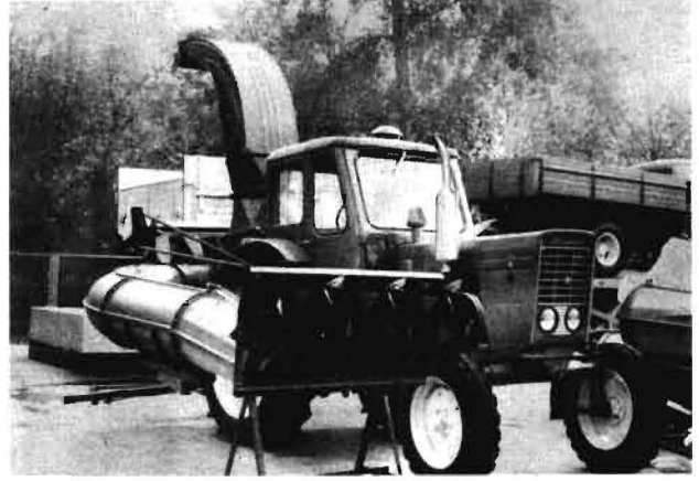
Bild 6. Der Anbau-Strohreißer FN-1,2 dient hauptsächlich zur Entnahme von Stroh aus Schobern, ist aber auch zur Strohaufnahme aus dem Schwad einsetzbar
