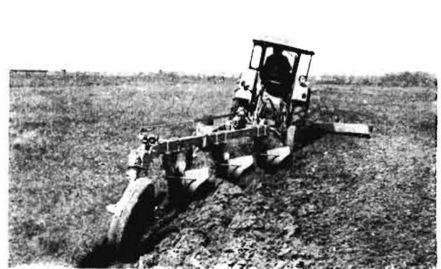
Bild 6. Anhängeschieber B 187 für eine Bodenbearbeitung bis 40 cm Tiefe
