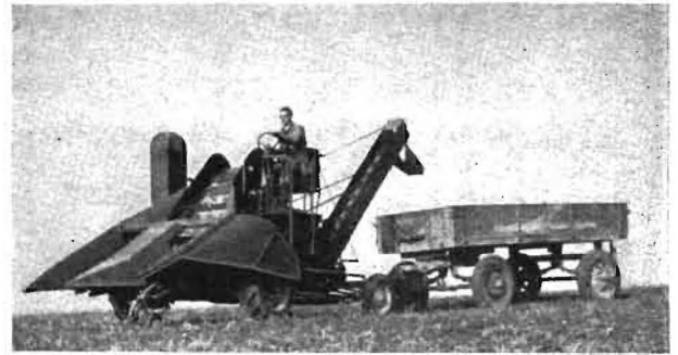
Bild 3. Selbstfahrender Pflücker-Entliescher Massey-Harris
