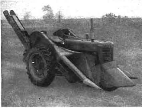
Bild 2. Aufgesetzter Pflücker-Entliescher No 2-ME, McCormick
