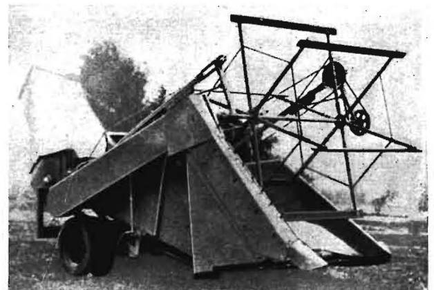
Bild 5. Zwang-Halmteiler mit Daumenkette (Seitenansicht)
