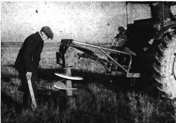
Bild 1. Erdlochbohrer der MTS-Spezialwerkstatt Oschersleben am „Belarus“ angebaut
