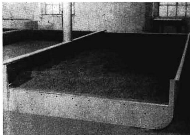
Bild 1. Trocknung auf einfachen Siebflächen
