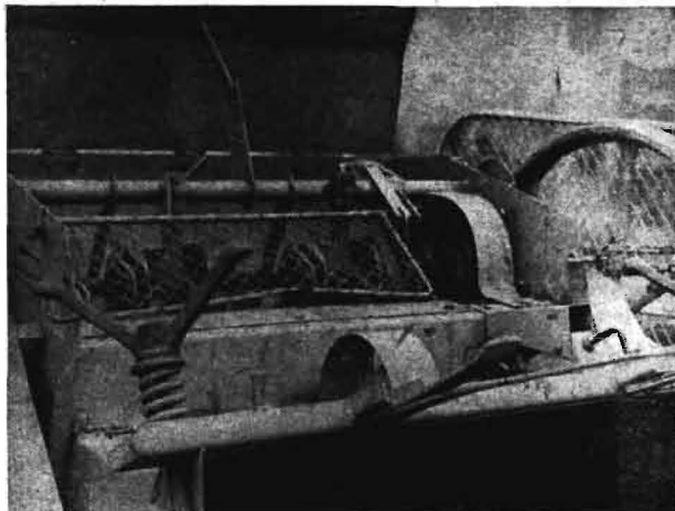
Bild 1. Knüpferschutz an Strohpresse
