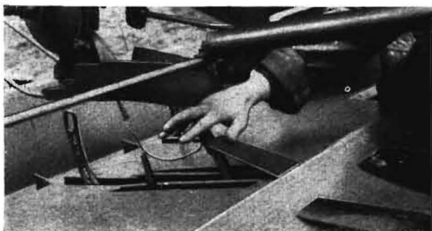
Bild 2. Erster Gefahrenbereich – ungeschützte Nadelführung über dem Tisch einschließlich Knüpfers. Gefahrenbereich liegt im unmittelbaren Hand- und Arbeitsbereich der zweiten Bedienungsperson
