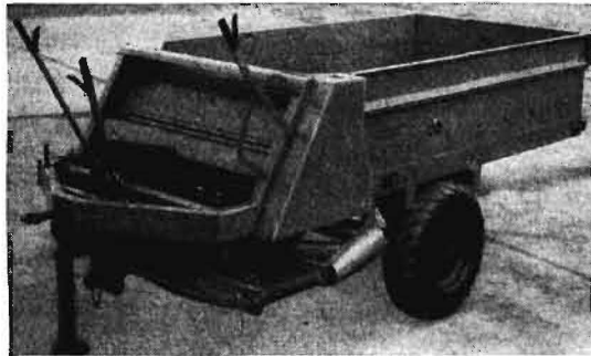
Bild 12. Stationärer Saffutterdosierer in der Versuchsanlage in Bornim (Im Vordergrund Rohrleitungen der Kraftfutterdosieranlage)
