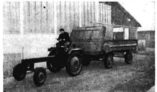
Bild 13. Von der Saffutterdosieranlage mechanisch beschickter fahrbarer Futtertisch
