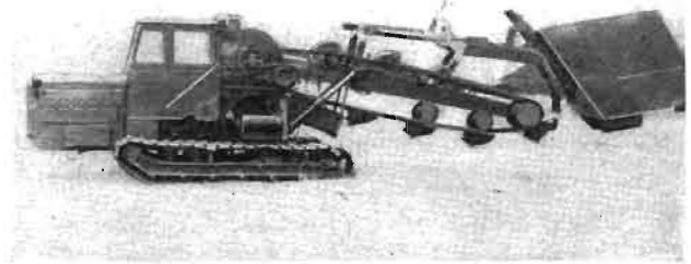
Bild 1. Der sowjetische Drängrabenbagger ETN 171
