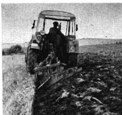
Bild 5. Gleiche Einsatzverhältnisse wie in Bild 4. Beetpflug B 110/3 mit G-Körpern und Vorschälern erzielt verhältnismäßig gute Wendung und Krümelung
