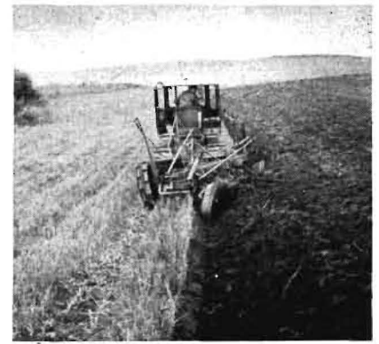
Bild 3. Anhänge-Scheibenpflug B 144/4 auf lockerem Lehmboden. Arbeitstiefe 25 cm, befriedigende Arbeitsgüte
