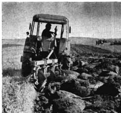
Bild 4. Auf schwerem, zähem Lehm ungenügende Arbeitsqualität des Scheibenpfluges (B 137-3/25)
