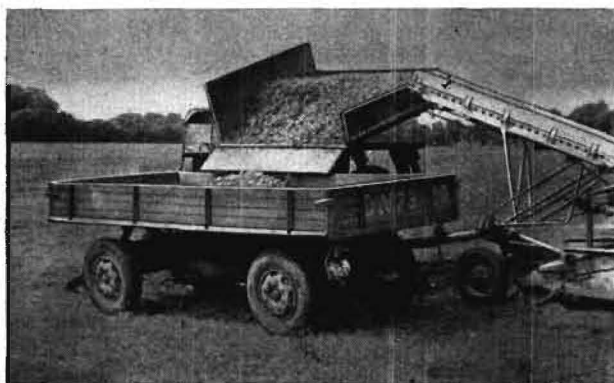
Bild 12. Versuchsausführung eines Allradschleppers mit Hochkippbunker (1,5 t Speicherkapazität) beim Überladen des Rodegutes auf Standwagen
