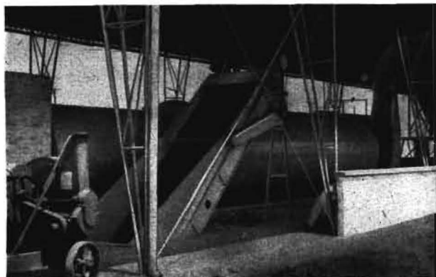
Bild 2 Van den Broeck-Trocknungsanlage: Häcksler, Höhenförderer und Trommel
