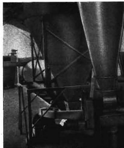
Bild 2 Van den Broeck-Trocknungsanlage: Häcksler, Höhenförderer und Trommel
