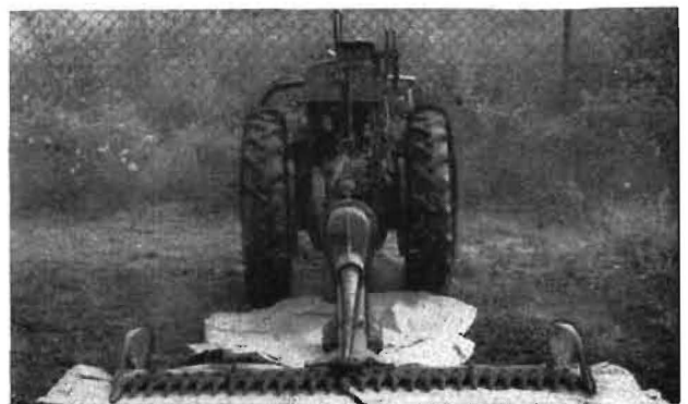
Bild 2. Frontschneidwerk Z 151 am Einachsschlepper PF 6
