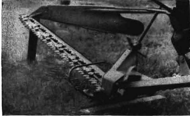
Bild 4 Fingerloses Schneidwerk (Funktionsmuster Juni 1960)
