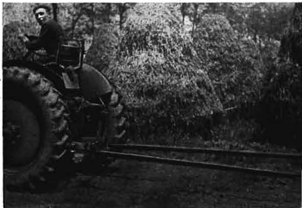
Bild 2. Auf die Zetorhydraulik montierte, 3 m lange Schienenstücke
