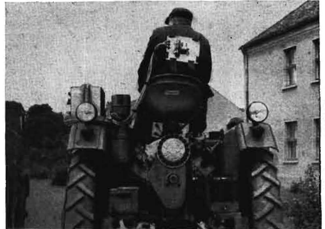
Bild 3. Schwingungsmessungen an Schleppersitzen. Grundplatte mit Beschleunigungsgebern zur Messung der Beschleunigung in drei Richtungen auf dem Rücken des Schlepperfahrers. Auf dem Kotflügel des Schleppers die Eingangsstufe des Gerätes, auf dem nebenherfahrenden Fahrzeug Ausgangsstufe und Oszillografen als Schreiber. Verbindung zwischen Ein- und Ausgang durch Kabel
