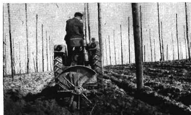
Bild 6. Freilegen der Hopfenstöcke mit dem Dammräumer B 179
