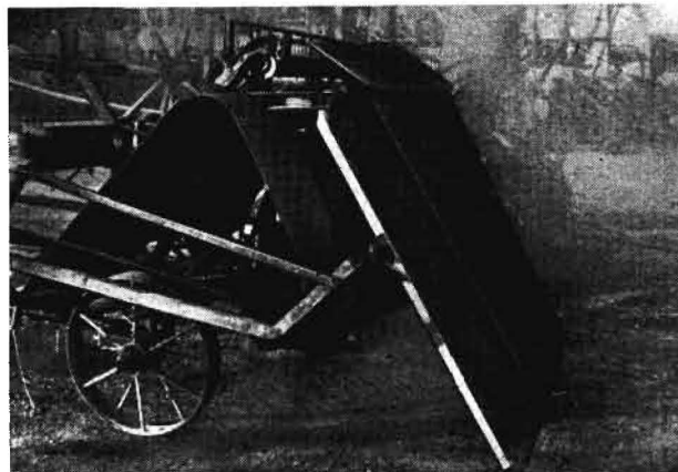
Bild 4. Mähbinder als Schwadmäher mit schwenkbarem Leitblech
