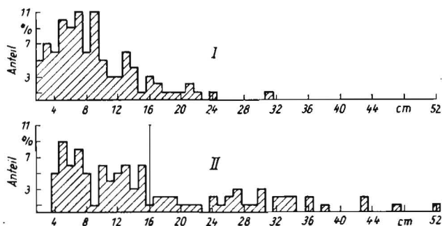
Bild 5. Häcksellängen bei Luzerne; Schlegelernter E 068 (nach STOLZENBURG). I Fahrgewicht 3,17 km/h, Trommeldrehzahl 1050 min -1 , mittlere Häcksellänge 9,09 cm; II Fahrgeschwindigkeit 5,29 km/h, Trommeldrehzahl 1050 min -1 , mittlere Häcksellänge 16,15 cm
