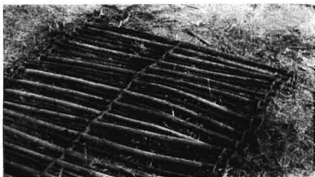
Bild 1 Hülsenkette von der E 675. Mit dieser Kette wurden nur wenige Kartoffeln gerodet. Es ist erkennbar, daß sich einige Laschen gelöst haben und Hülsen verbogen sind
