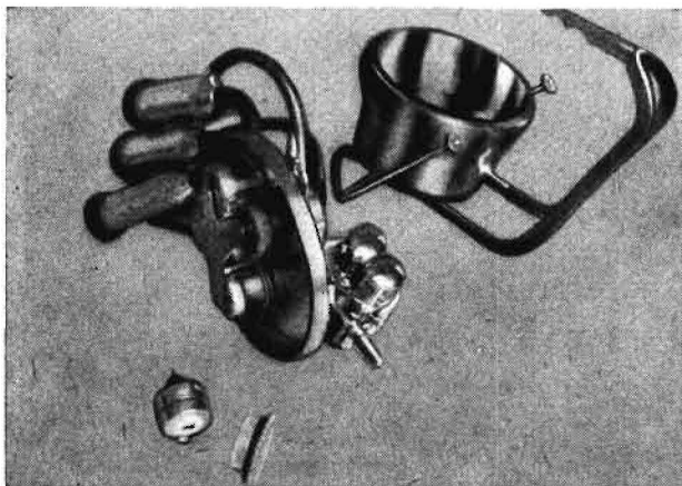
Bild 8. Innenansicht des Melkzeugs der amerikanischen Melkmaschine New Perfection mit automatischer Unterbrechung des Vakuums bei jedem Melkbecher nach Beendigung des Milchflusses
