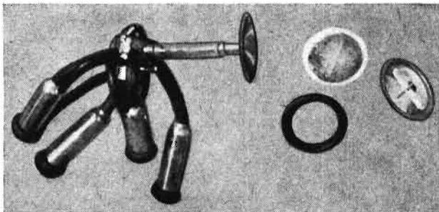
Bild 7. Milchfilter für jedes Melkzeug beim Melkstand Fabrikat Chore Boy
