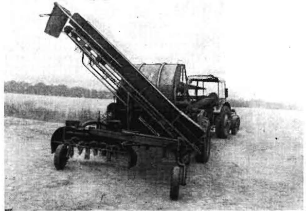
Bild 3. Wagenköpfröder E 710/4, Wagenförderer in Transportstellung, Nachläufer mit kleiner Spurweite
