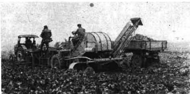
Bild 2. Wagenköpfröder E 710/4 gezogen vom RS 14/46 bei der Arbeit, Nachläufer mit großer Spurweite
