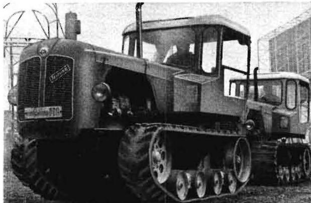
Bild 12. Neue Gleisketten aus Gummi bzw. mit Perlonrippen
