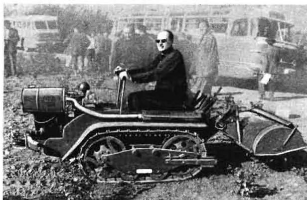
Bild 2. „Ransomes“-Traktor mit Hackfräse
