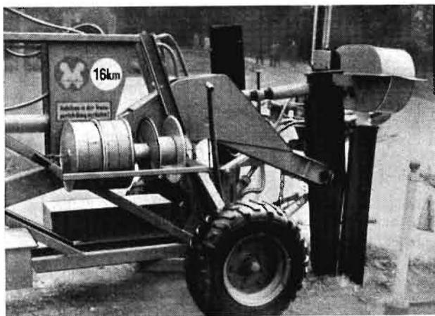
Bild 14. Seitenansicht des Maulwurfrohrrängeräts
