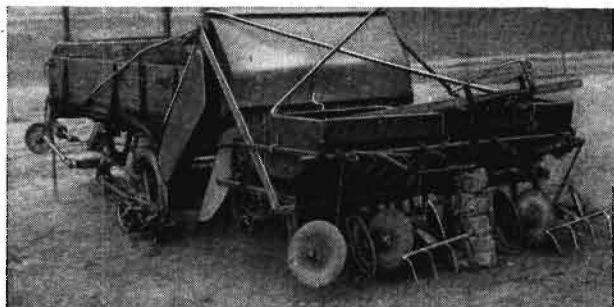
Bild 8. Einachs-Stallungstreuer mit angebaute Kartoffellegemaschine. Der Stallmist fällt in Streifen direkt in die Furchenreihen (Kiew)
