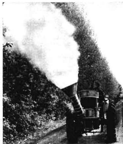
Bild 6 Stäubmaschine „OPSS-30 B“ beim Bestäuben eines Waldschutzstreifens
