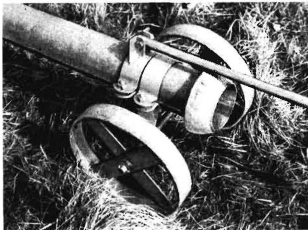
Bild 3. Radkarren für eine als Zugleitung ausgebildete Schallleitung
