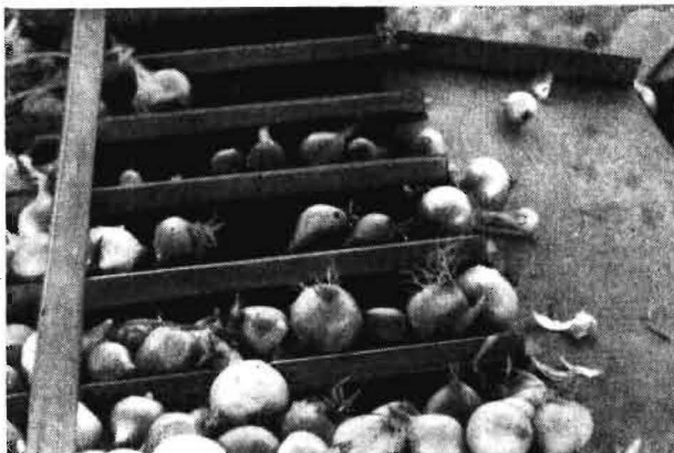
Bild 2. Putzelemente der Zwiebelputzmaschine B 907
