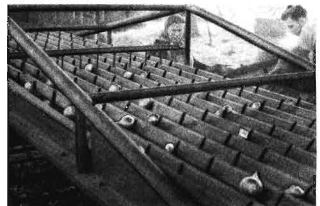
Bild 3. Sortierelemente der Zwiebelsortiermaschine B 908
